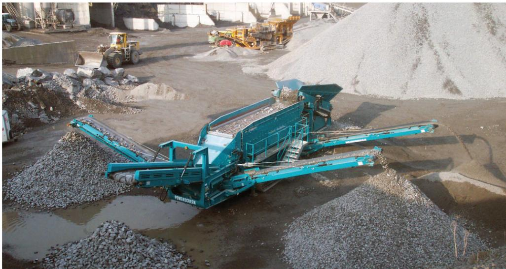
Die Abbildung veranschaulicht eine der beiden Horizontalsiebmaschinen zur Selektion von Edelsplitten 0/16 mm.
